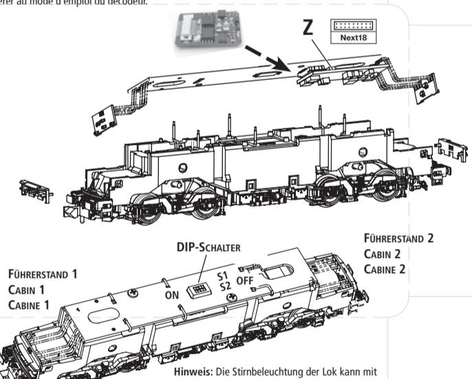
Hinweis: Die Stirnbeleuchtung der Lok kann mit Hilfe des DIP-Schalters S1 (für FS2) oder S2 (für FS1) auf der Platine für jede Lokseite abgeschaltet werden.
